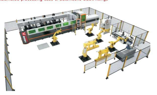
自动化加工流程:成捆圆管上料或者成型管件机械手1上料,激光切管机自动切割,机械手2抓取管件到 冲床,冲床冲压凹槽,机械手3抓取管件到弯管机,弯管机自动弯曲管件,机械手4抓取管件到弯管搁置
