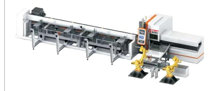
自动化加工流程:成捆紧铜管全自动上料送料,激光切管机自动切割,履带收料分料,机械手清洗工件,机械手成品码垛。
